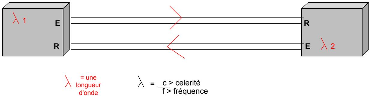
Hier, on injectait une  $\lambda$  par fibre optique, d'où pour une liaison il fallait deux fibres: une pour l'émission et une autre pour la réception
