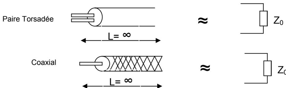
Règle : Quelque soit le câble, on le referme toujours sur son impédance caractéristique. Car si on ne le fait pas, l'impédance est alors très élevée, voire infinie et toute l'énergie ne peut pas être absorbée par celle-ci, d'où le signal va être réfléchi et celui ci rentrera alors en collision avec le signal incident.
