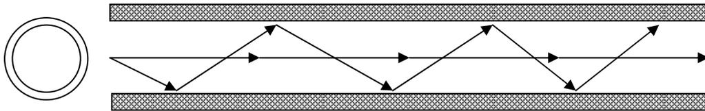
Les fibres à gradient d'indice sont obtenus en donnant au cœur un indice de réfraction non uniforme, qui permet d'accélérer la vitesse du rayon à mesure qu'il s'éloigne du centre. La bande passante de ce câble peut atteindre le GHz.
